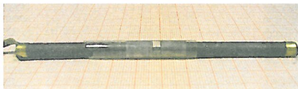
Fig. 1 - Ricostruzione moderna per uso didattico del coherer a polveri magnetiche. Pochi millimetri di polvere di lega ferro-nichel sono interposti, senza pressione, tra due elettrodi di carbone - recuperati da vecchie pile Leclanchè -. Il tutto è sistemato all'interno di un tubetto di vetro
